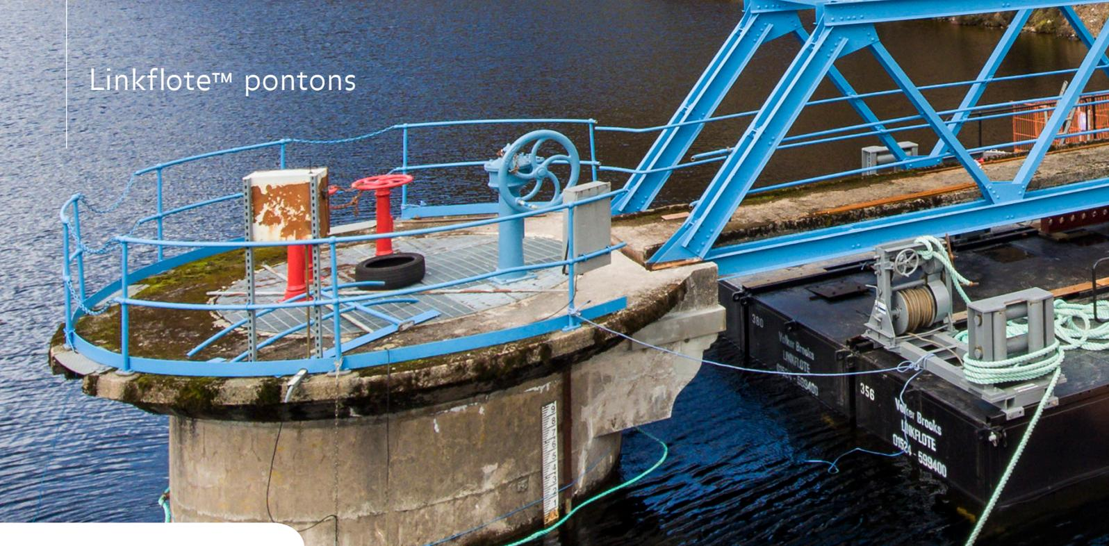
Les pontons Linkflote™ sont des pontons de flottaison modulaires polyvalents, transportables par route et faciles à manipuler, utilisés pour les infrastructures maritimes temporaires et permanentes, les applications de transport, le génie civil et les aménagements maritimes dans le monde entier.
